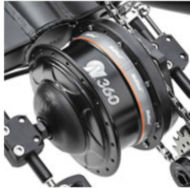
Nuvinci automatgir. Leveres som et helautomatisk, elektronisk gir.
