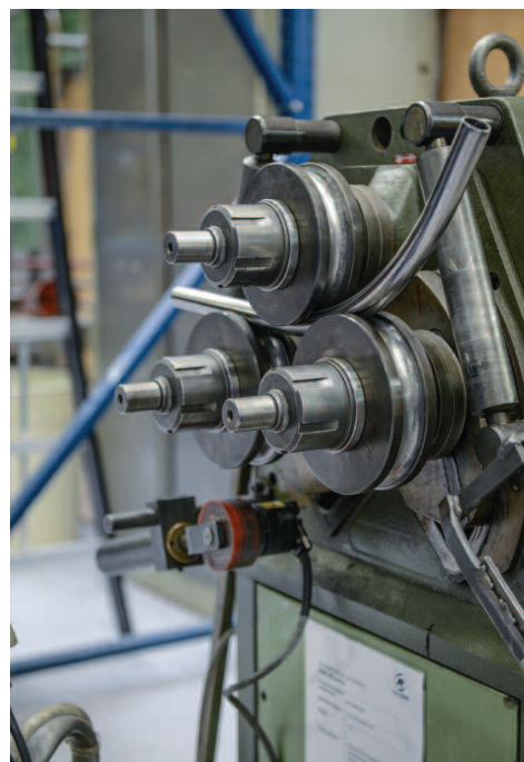
Bøying av rør
