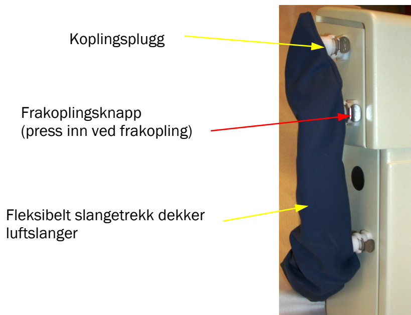
Fig. 1 Tilkopling av luftslanger
