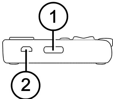
På venstre side av enheten, når du beveger deg fra forkanten og bakover, finner du en avlang Av/På knapp (1), og en standard mikro USB port (2). USB porten gjør det mulig å koble leselisten til en PC med den medfølgende USB kabelen, eller til strømadapteren.
