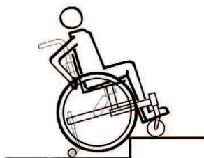
Figur 8b: Fjern tippesikring i møte med trapper og humper
