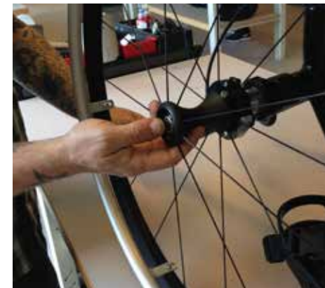
Fig. 11 demontering/montering av hjul og nedlegging av rygg
