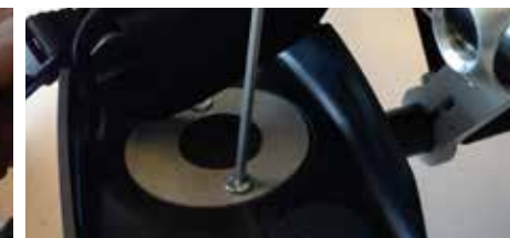
Fig. 02b Bredden og vinkelen justeres ved å løsne to skruer på oversiden av fotbrettet.
