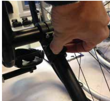
Fig. 09b Dra plunger opp og tippesikring ut
