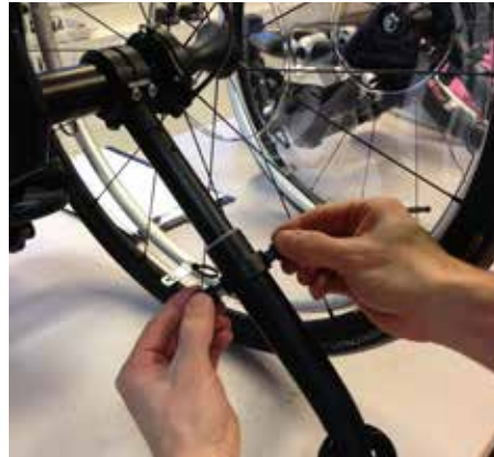
Fig. 09d Endre tippesvinkel - dra begge plunger ut, vri 180 grader
