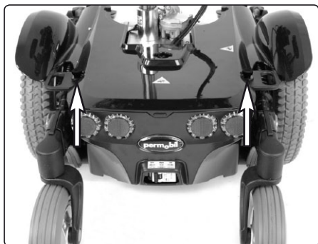
Det øvre chassisdekselet er festet med to knotter.
