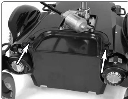
Det fremre chassisdekselet er festet med to knottene.
