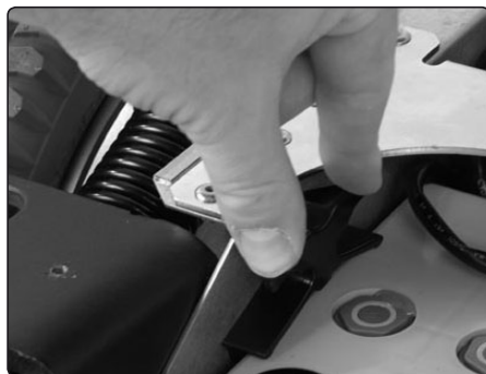
På noen modeller er batteriene sikret med batterilås.
