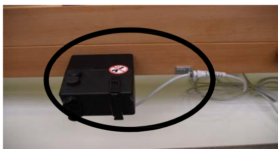
Fig. 4: Strekkavlaster og styreboks festet på montasjeplaten
