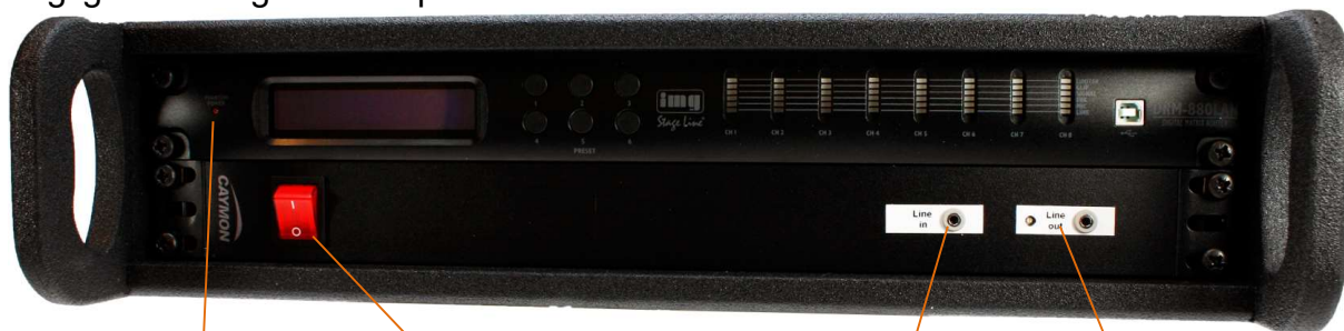
(A) Rødt lys = På (B) På/av-bryter (C) Linje-inn (D) Linje ut m/ justering
