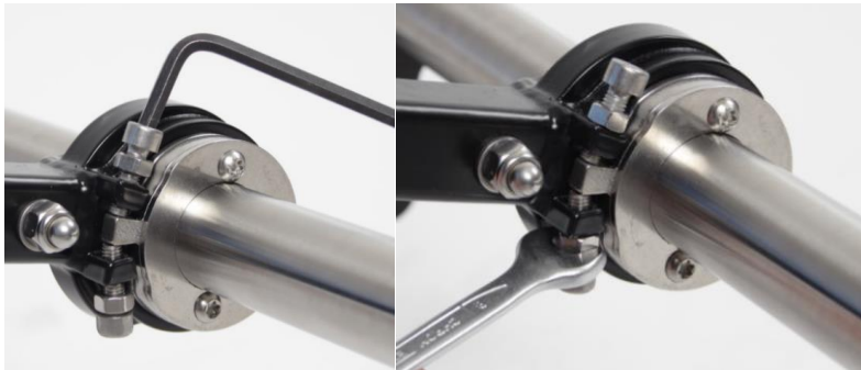
Fig. 27 Skru inntil skuer med 4mm Umbrako og stram kontramutter med 8mm fastnøkkel.
