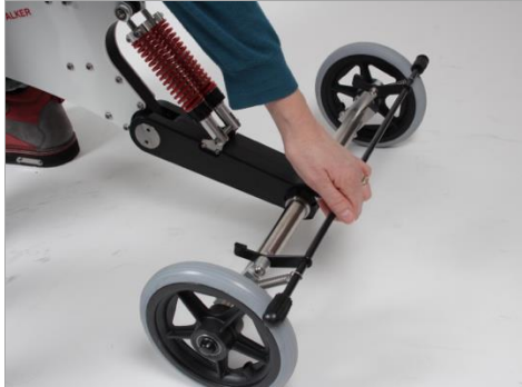
Fig. 20 Sett på bremsen
