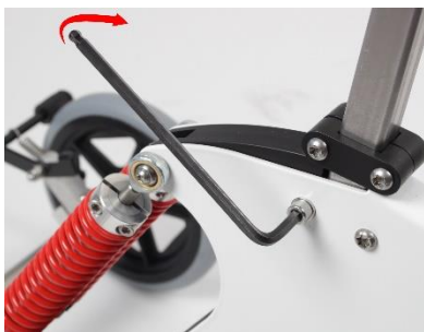
Fig. 29 Skru til skruene på begge sidene
