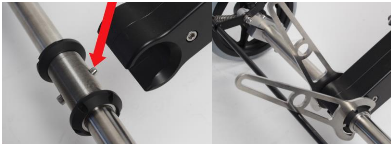
Fig. 28 Skru inntil skuer med 4mm Umbrako og stram kontramutter med 8mm fastnøkkel.
