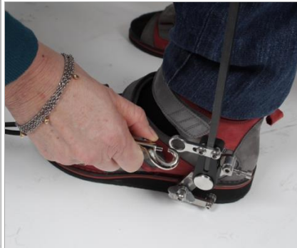
Fig. 21 Ta føringsremmer/strikk av skinnen
