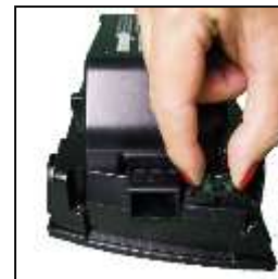
Fig. 65 Udskiftning af sikring
