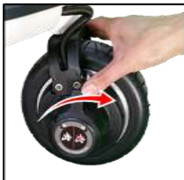
Fig. 51 Indstilling af frihjul
