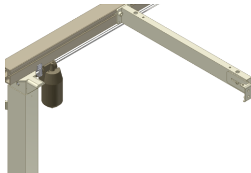
7.1.6 Alle bordplatebæringer minst 2 stk. monteres nå inn på alu.profilen fra høyre side, og fordeles så de har en innbyrdes avstand som ikke overstiger 60 cm
