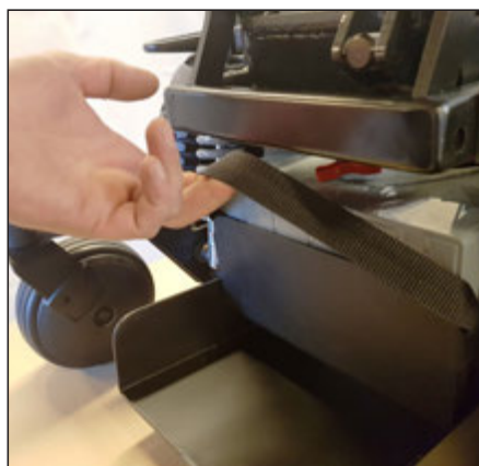
Ta tak i batteriremmen og dra ut batteriskuffen
