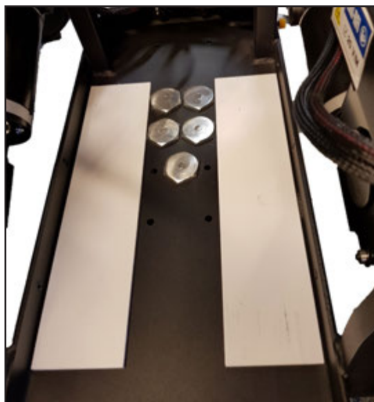
De två medföljande plattorna placeras på vardera sida om muttrarna. De fästs med dubbelhäftande tejp eller lite lim.
