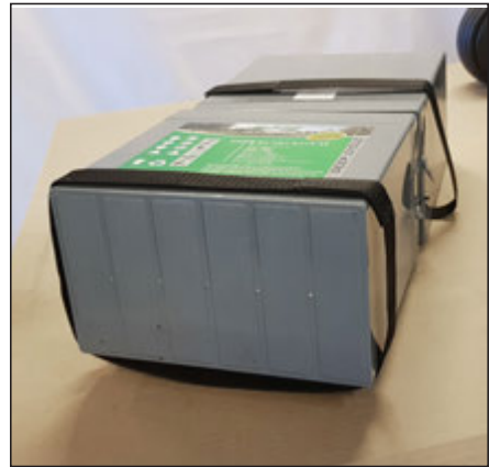
Legg batteriene med polene mot hverandre.
