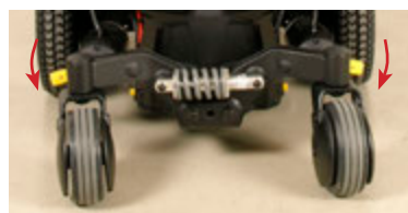
Posisjon for frikobling - skjøvet ned
