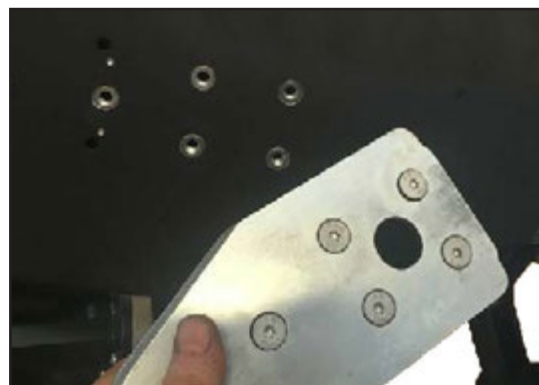
De medfølgende skruene plasseres i låseplaten, og skrues opp i mutterne.
