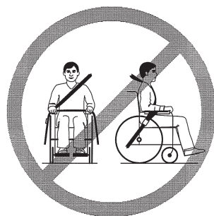
Feil bruk av belte
