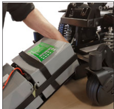
Sørg for at kontakten vendes ut mot åpningen. Før batteriskuffen på plass.
