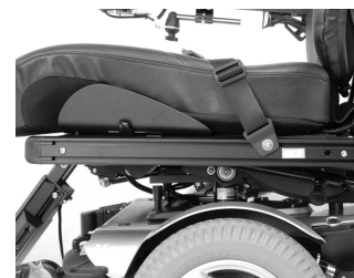
Montert belte, venstre side.
