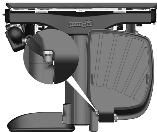
Billede 19. Fotplatenes vinkel kan justeres ved hjelp av en skrue som festes med en kontramutter.
