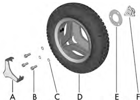
Billede 157. Montering av drivhjulet.
