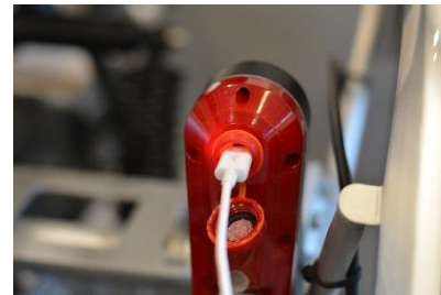
Skru mot klokken for å åpne ladelokket. Benytt RollerSafe laderen ved opplading
