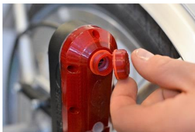
Skru mot klokken for å åpne ladelokket. Benytt RollerSafe laderen ved opplading
