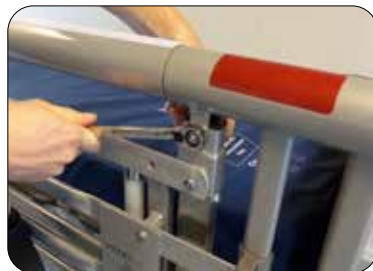
Monter igjen mutter og bolt
