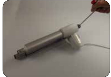
Fjerne unbrakoskruer og løsne aktuatoren
