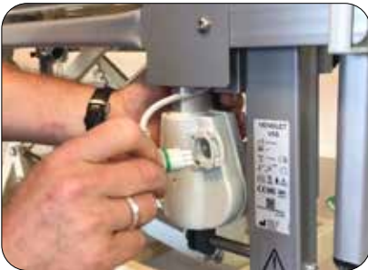
Koble til aktuator kabel.
