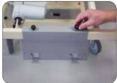
Skrue fast opphengsplaten med de to fingerskruene
