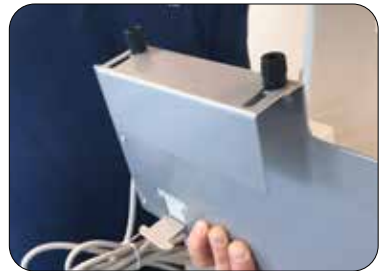
Løse skruene på opphengsplaten til kontrollenheten
