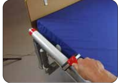
Kjør med en hard rull over borrelåsen
