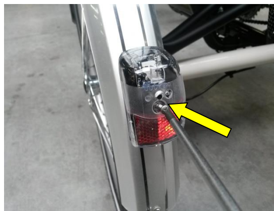
Sett på frontdekselet og fest skruen
