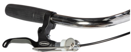
Fig. 1 Parkeringsbremsehendel Flytt denne hendelen for å koble parkeringsbremsen inn/ut
