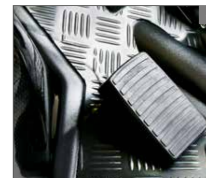
FOTGASS: Alene eller i kombinasjon med håndgass.
