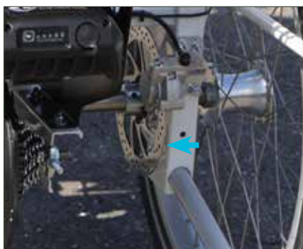
Hydrauliske brems er – på alle tre hjul.
