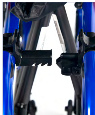
Quickie Life - enkel å legge sammen for transport eller lagring. Låser når sammenslått
