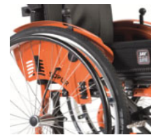
Brems, Skyv for å låse, integrert i klesbeskytter, Safari
