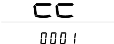
1 代表 1 粒磁钢数 (车轮每转 1 圈输出一个信号)
