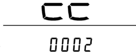
2 代表 2 粒磁钢 (车轮每转 1 圈输出 2 个信号)
